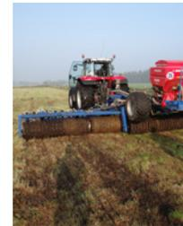
Abb. 5: Striegeln einer Fläche mit Saatstriegelkombination
